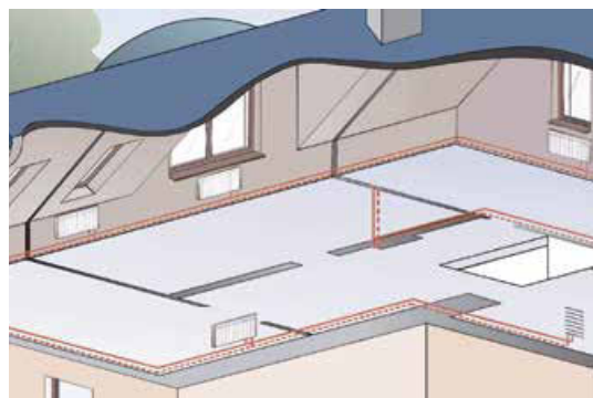
Heizkörperanschlüsse in einer Ringleitung ausgeführt
