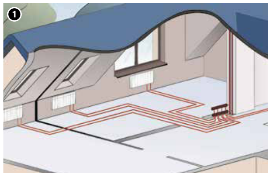
1. Verteilersystem der Heizanlage
